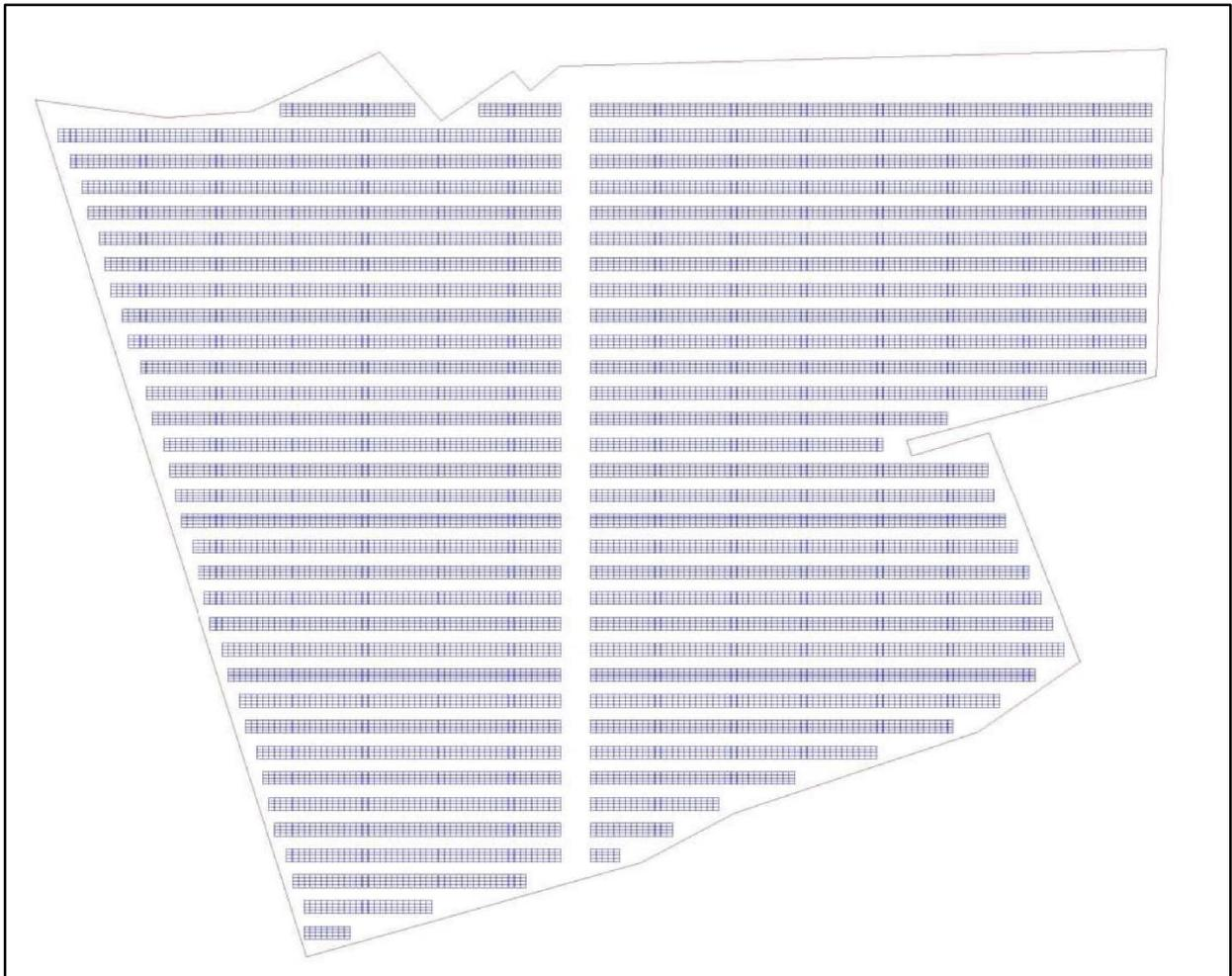
Abbildung 6: Mögliche Anzahl und Anordnung der Modultische (Quelle: solar-project-solution GmbH)
